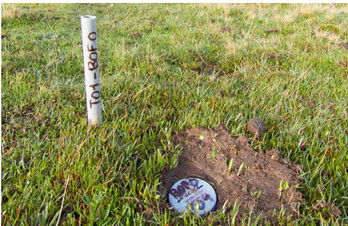
Tubo de observación instalado en la microcuenca testigo para la medición de la profundidad de la napa freática en bofedales. Foto: Jan R. Baiker.
